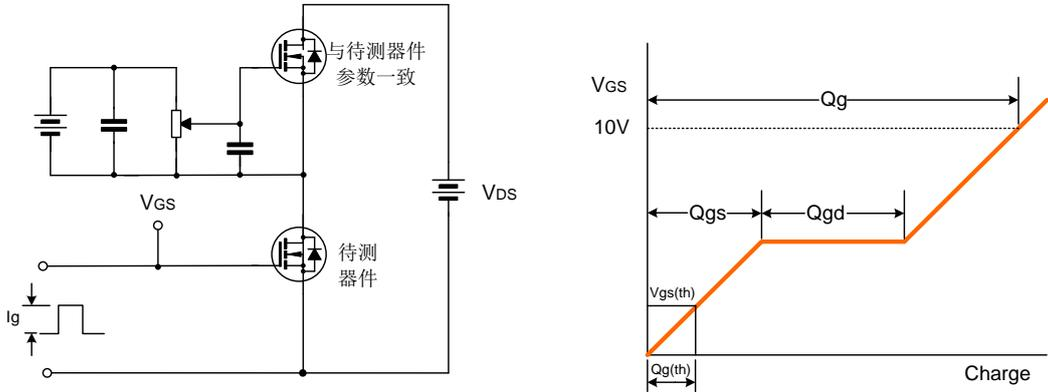
图5-1 栅极电荷量测试电路及波形图
