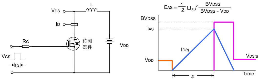
图5-3 EAS测试电路及波形图
