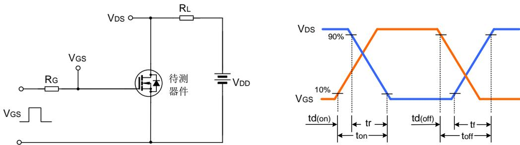
图5-2 开关时间测试电路及波形图
